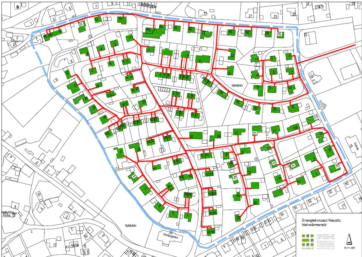
Abb.: Mögliche Netzvariante (Kompletterschließung), eigene Darstellung
