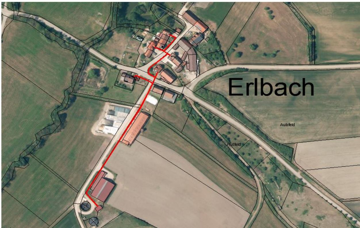
Abb.: Nahwärmenetz Erlbach, eigene Darstellung
